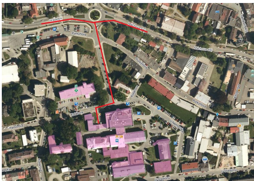
obr.č.3 Napojení staveniště na dopravní infrastrukturu a trasy staveništní dopravy
